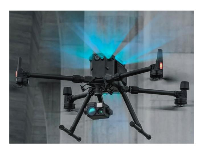
Para mejorar la seguridad y la estabilidad de la aeronave durante el vuelo, la aeronave cuenta con sensores de doble visión e infrarrojos en sus seis lados. Esta mejora ofrece un mayor alcance de detección de hasta 40 m.
